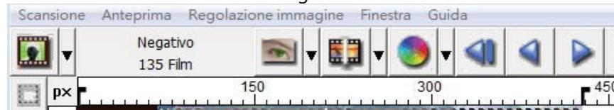
Strumento di regolazione fotogramma (LINGUETTE) se la pellicola non è correttamente allineata dopo l'inserimento, è possibile utilizzare queste LINGUETTE sul righello per regolare l'allineamento trascinando la LINGUETTA per l'allineamento con il bordo del fotogramma della pellicola
