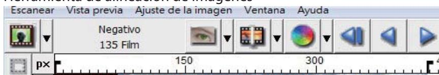
**Herramienta de ajuste de fotogramas (PESTAÑAS):** si la película está incorrectamente alineada, puede utilizar las PESTAÑAS de la regla para ajustar la alineación arrastrando la PESTAÑA para alinearla con el borde del fotograma de la película
