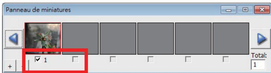
Lorsque vous scannez plus de 6 images (6 à la fois peuvent être vues dans le panneau miniature), vous pouvez défiler pour afficher plus en cliquant sur le bouton flèche droite. Les boutons flèche gauche/droite vous permettent de défiler les images pré-scannées facilement. Ce modèle de scanner est capable de scanner un rouleau entier (non découpé) de jusqu'à 40 images.
