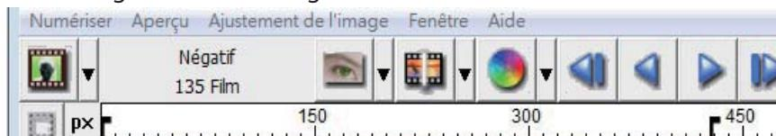
Outil d'alignement de l'image (TABS) - Si votre film est mal aligné après l'avoir inséré, vous pouvez utiliser ces TABS sur la règle pour ajuster l'alignement en déplaçant le TAB pour l'aligner avec le bord du film.
