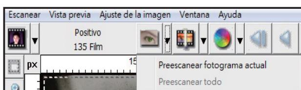
La predigitalización debe usarse para ajustar manualmente la configuración de color y edición para cada diapositiva antes de realizar la digitalización final. Es posible establecer diferentes configuraciones para cada diapositiva que se va a digitalizar.
